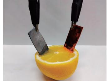
(1) レモン電池1個を電子オルゴールにつなぐと音がなりましたが、発光ダイオードにつないでも光りませんでした。そこでレモン電池2個を工夫してつないだところ、発光ダイオードが光りました。①～⑤のうち発光ダイオードが光るものを1つ選んで、番号で答えなさい。ただし、発光ダイオードのプラスマイナスの向きは気にしなくてよく、レモンにささっている金属板は茶色が銅を、灰色が亜鉛を表しているとします。
